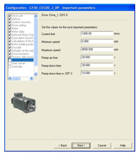
Figure 5-28 Important parameters
